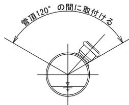
・支管は流水を阻害しないよう、支管の管底が本管の中心より下方にならない位置に取付ける。
