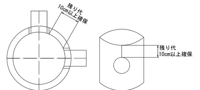
削孔径同士の間隔（残り代）は内面側で10cm以上確保すること
