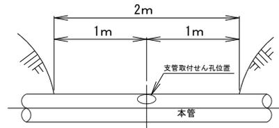
・後掘りをしてせん孔を行うときは、管の内部応力を減少させるためせん孔部分を中心に本管軸方向に2mの部分の土を取り除く。
